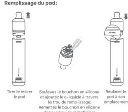
• Lorsque vous replacez le pod, assurez-vous que la bouche est alignée avec la position du trou pour le flux d'air.
